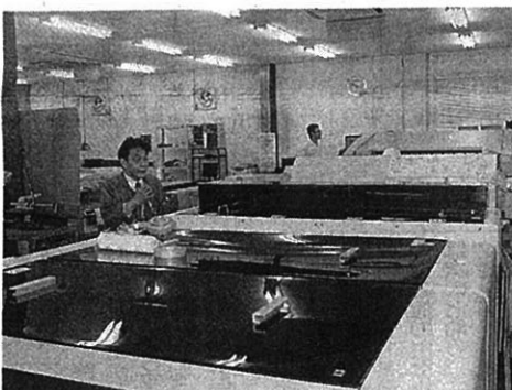
水なし専用として使用される富士フイルム Luxel T-9800のライン
